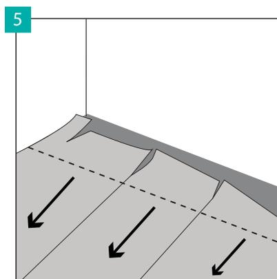
Снимите часть защитной пленки и приклейте панели к непокрытой части, укладывая их плотно друг к другу и не оставляя зазоров. Клей на мате может находиться без защитной пленки не более 30 минут, поэтому необходимо приклеивать панели в течение этого времени.
