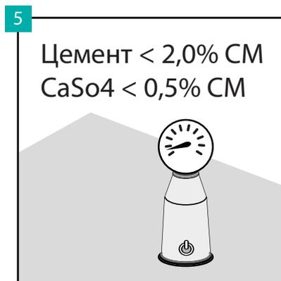
В случае цементного основания содержание влаги в нем должно быть ниже 2,0%, а в случае ангидритного - ниже 0,5%. В случае установки системы подогрева пола вышеупомянутые значения должны составлять 1,5% и 0,3% соответственно.
