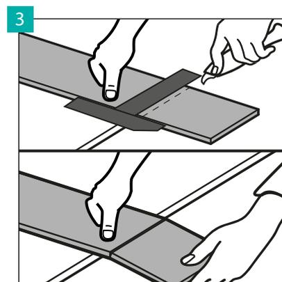
Для дополнительной обрезки панелей используйте острый нож, надрежьте верхний слой, а затем отломайте панель, наклонив ее по краю. Панели для пола также можно легко разрезать с помощью электрической пилы.
