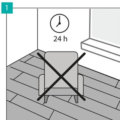
Если панели устанавливаются на подложку с помощью клея, тяжелые предметы можно размещать только через 24 часа после приклеивания, а по полу можно осторожно ходить через 4 часа после приклеивания.
