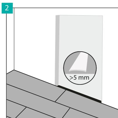
Соединения соседних напольных покрытий должны быть отделаны декоративными профилями, оставляя компенсаторы расширения, указанные производителем.
