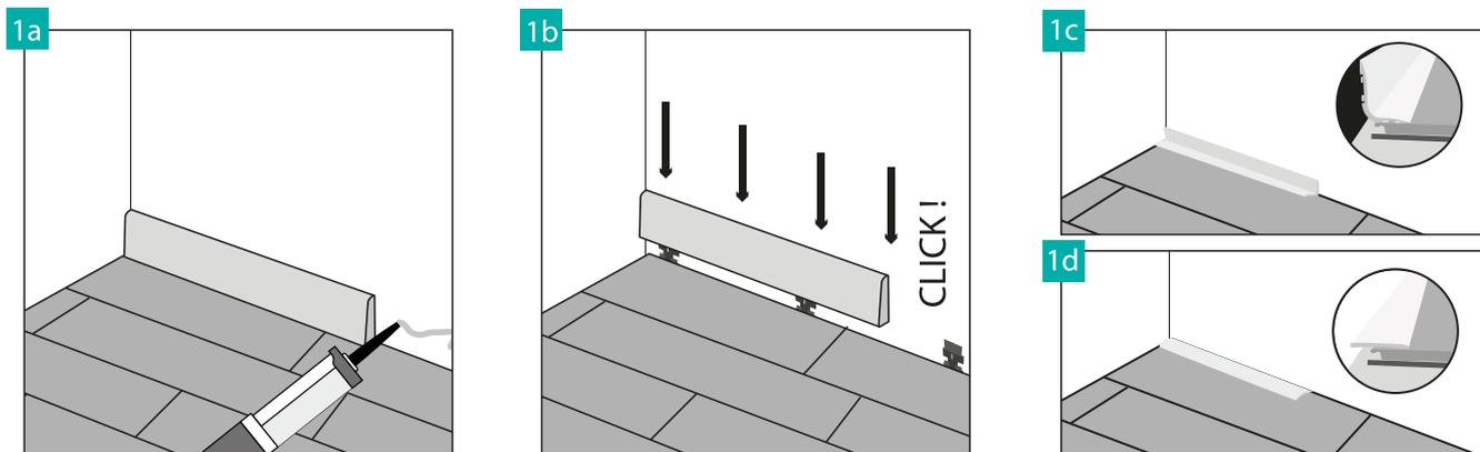
Компенсаторы расширения вдоль стен должны быть покрыты декоративной полосой, установленной при помощи клея или специальных зажимных скоб. Рекомендуется использовать полосы Arbiton, предназначенные для данной панели, которые гарантируют превосходное соответствие цвета и покрытие, стойкое к царапинам.
