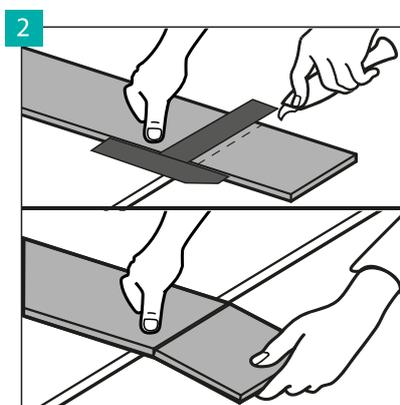
Для дополнительной обрезки панелей используйте острый нож, надрежьте верхний слой, а затем отломайте панель, наклонив ее по краю.
