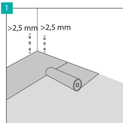
Укладывайте подложку Arbiton Multiprotec LVT Fastlay HD или Ewifoam Vinlay Rapid HD в направлении, перпендикулярном направлению укладки панелей, оставляя у стены компенсатор расширения размером 2,5 мм. Соседние полосы подложки должны устанавливаться плотно друг к другу, не оставляя лишнего пространства.
