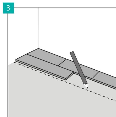
Определите контрольную линию, чтобы покрыть часть подложки клеем и приклеить панели.
