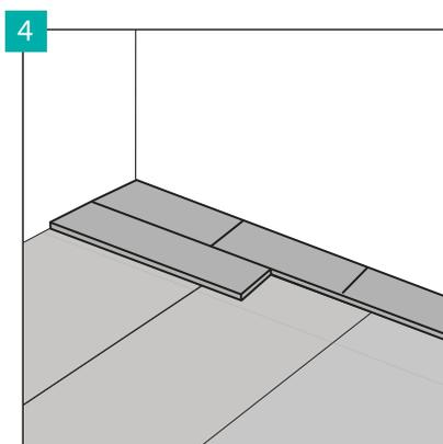
Панели должны укладываться перпендикулярно направлению расстилания установочного мата. Перед приклеиванием панелей к установочному мату распределите их по поверхности и проверьте их расположение. Панели должны укладываться таким образом, чтобы они перекрывали данную полосу мата минимум на 10 см.
