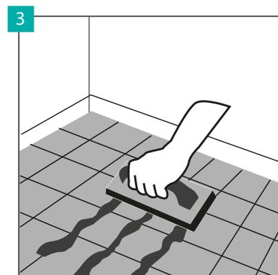
В случае установки на подложку, покрытую керамической плиткой, заполните стыки плитки прочным составом для заделки швов, например, эпоксидной смолой. При использовании мата с клеевыми слоями Arbiton Multiprotec LVT Fastlay или Ewifoam Vinlay Rapid HD нет необходимости заполнять швы плитки толщиной до 3 мм и глубиной 1,5 мм.
